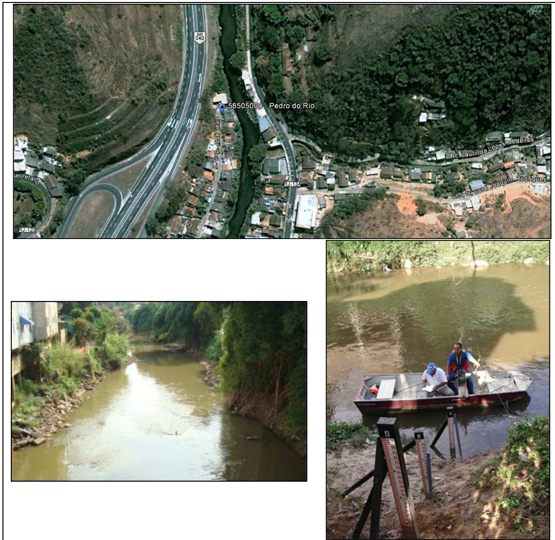
Figura 14: Localização da Estação Fluviométrica Pedro do Rio e Medição de Vazão na Seção. Fonte: COPPE/UFRJ (2010) e Google Earth 6.2.
